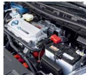
12Vバッテリーは補機類に電源を供給している。動力用モーターにはリチウムイオンバックが電源を供給する。
